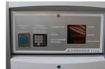
Клавиатура задания дозы и считыватель карт
